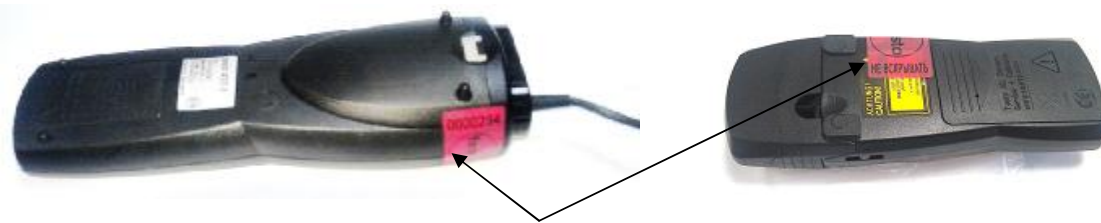
Разрушающиеся наклейки Рис. 4
